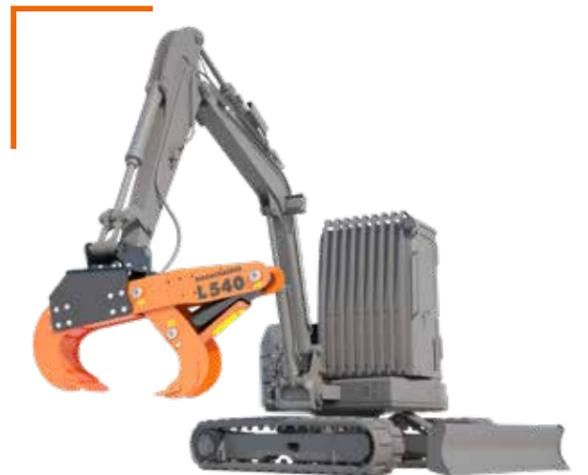
Grazie alla possibilità di montaggio sull'escavatore, il tronco può essere spaccato e caricato in un unico passaggio.
