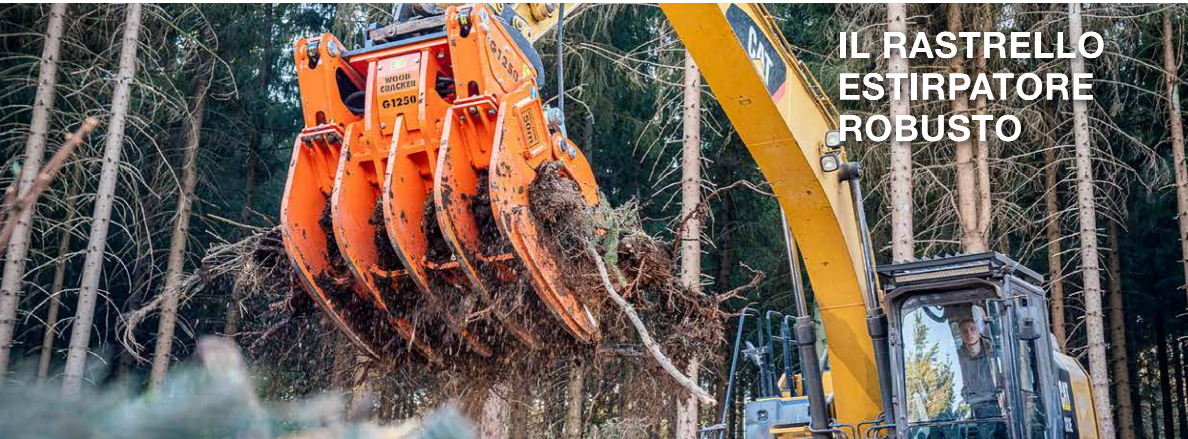
Woodcracker® G1250 con rastrello a denti fitti.
