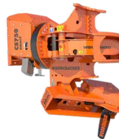
aktiv gefedert aufgehängter Sägekasten
