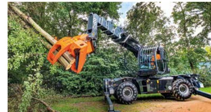
Tensionamento automatico della catena, a rotazione illimitata.
