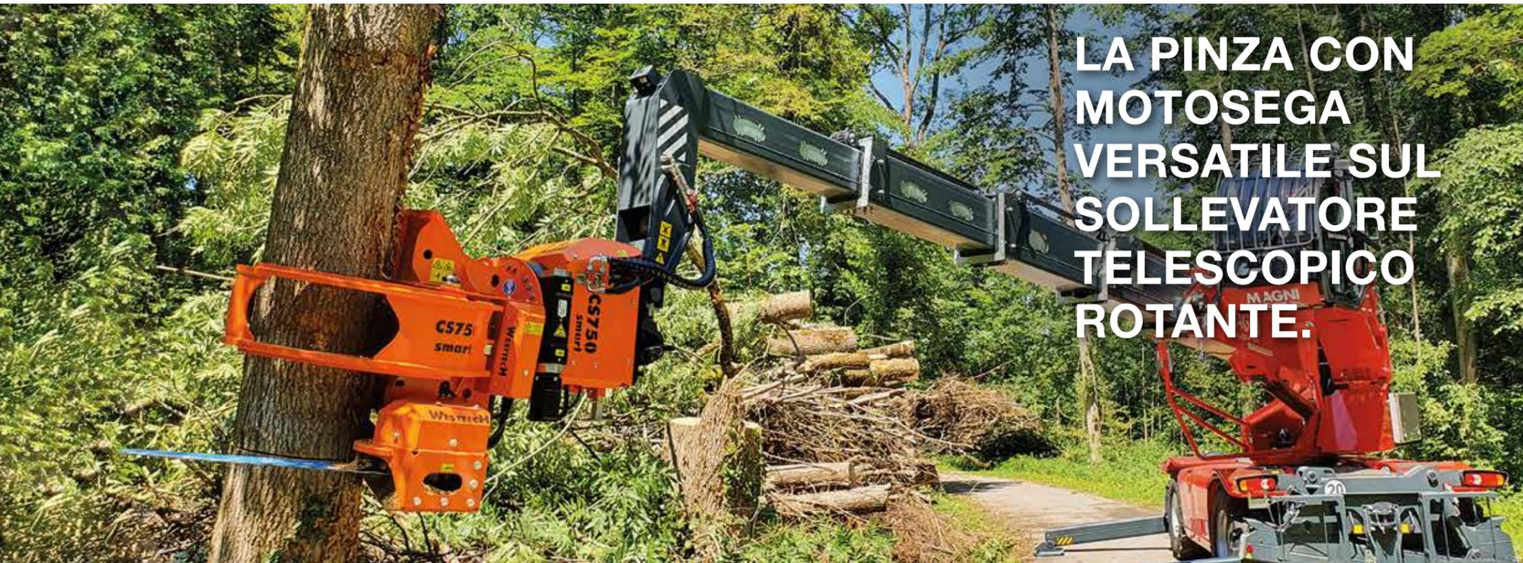
LA PINZA CON MOTOSEGA VERSATILE SUL SOLLEVATORE TELESCOPICO ROTANTE.
