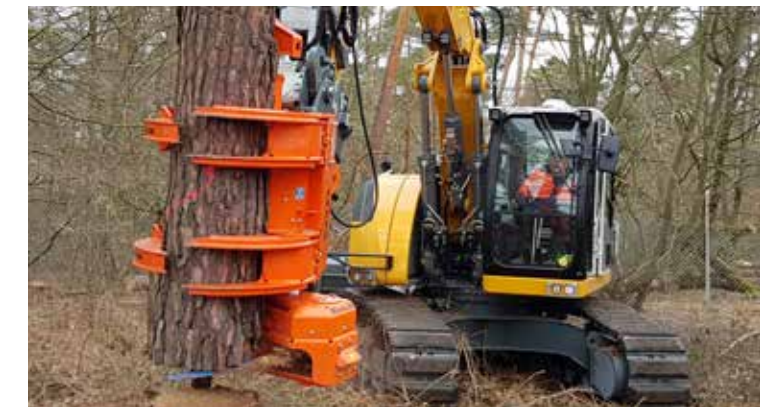
Le pinze potenti tengono saldamente in posizione l'albero.
