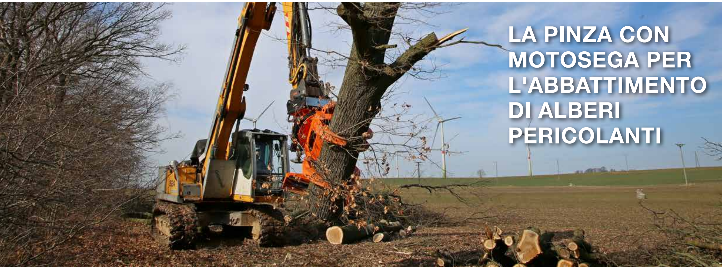
Le pinze potenti tengono saldamente in posizione l'albero.
